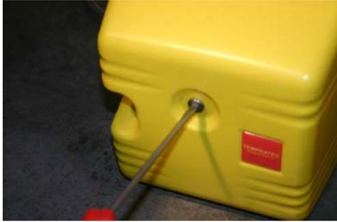
Befestigungsschraube an der C1 Brennerhaube mit Schraubendreher lösen und Brennerhaube abnehmen.
