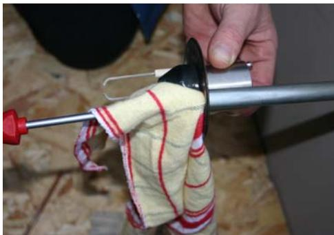
Lufthülse mit Messingdrahtbürste von Rückstände befreien.
