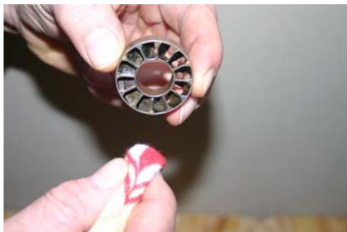
Turbulator mit Tuch reinigen.
