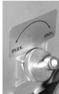
Der Luftüberschuss in der Verbrennung wird über die Luftklappe mit einem geeigneten Emissionsmessgerät angepasst.
