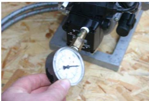
**Brennerölpumpe:** Stopfen mit beiliegendem Inbusschlüssel am Pumpendeckel (Zeichen P) rausdrehen und Manometer eindrehen. Um Druckverstellungen zu beobachten und verstellen zu können.
