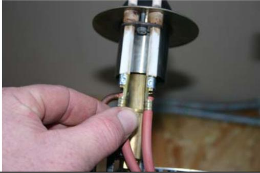
Zündkabel an den Zündelektroden abziehen.
