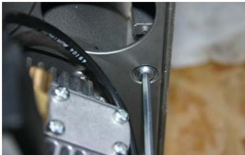
Vier -Zylinderschrauben am Brennergehäuse lösen und Gehäusedeckel abnehmen.
