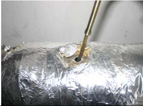
**Bei Brennerstart-** Meßsonde vom Emissionsmessgerät in das Messloch am Rauchrohr einführen und Abgaswerte beobachten.
