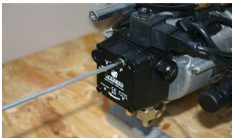
Nach einstellen der Messdaten und Brennerleistung , Brenner ausschalten, Manometer herausdrehen , Stopfen eindrehen und Brenner in Betrieb nehmen.
